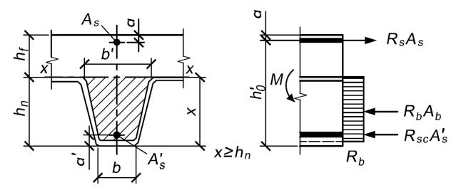
Рисунок 6.7 – Схема усилий в опорном сечении плиты при расположении нейтральной оси на уровне верхней полки профилированного настила
