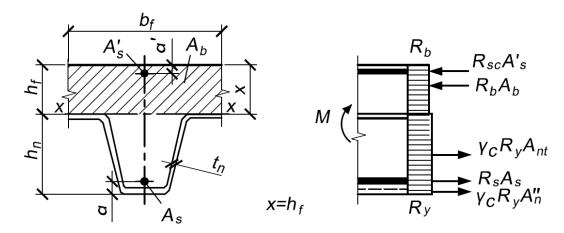
Рисунок 6.5 – Схема усилий в пролетном сечении плиты при расположенииней тральной оси на уровне верхней полки профилированного настила
