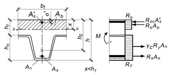
Рисунок 6.3 – Схема усилий в пролетном сечении плиты при расположении нейтральной оси в пределах толщины полки плиты
