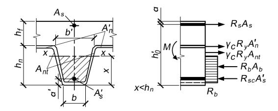
Рисунок 6.6— Схема усилий в опорном сечении плиты при расположении нейтральной оси в пределах стенки гофра профилированного настила
