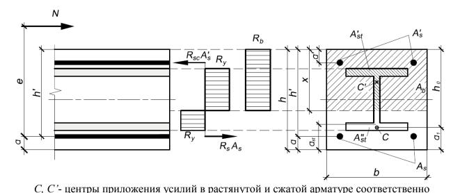
Рисунок 7.1 – Схема усилий и эпюры напряжений в сечении, нормальном к продольной оси внецентренно сжатого сталежелезобетонного элемента, при расчете его по прочности на примере случая прохождения границы сжатой
