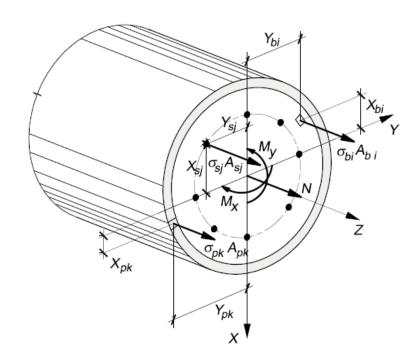
Рисунок 7.4 - Расчетная схема нормального сечения трубобетонного элемента В уравнениях (7.19) – (7.27):
