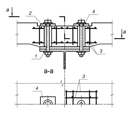
I — высокопрочный болт; 2 — отверстие в бетоне; 3 — арматурный каркас; 4 — распределительная подкладка
