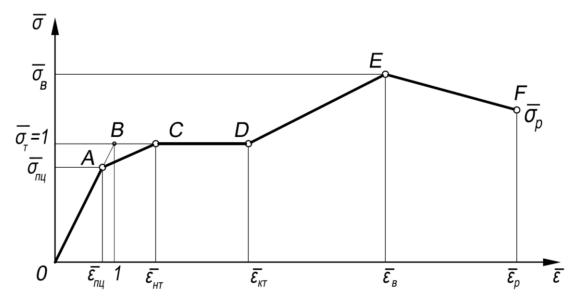
Рисунок Е.1 – Обобщенная расчетная диаграмма работы сталей
