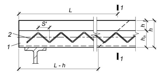
1 — стальной профилированный настил; 2 — выштампованные рифы; 1-1 — сечение по пролету настила в месте наибольшего изгибающего момента, в четверти пролета, в местах
