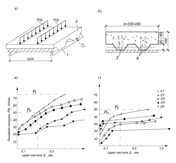
1 — профилированный настил; 2 — бетон плиты; 3 — опорная балка; 4 — стад-болт; а) — схема испытаний; б) — опорное сечение образца; в) — результаты испытаний образцов с стад-болтами на опорах; г) — результаты испытаний образцов без стад-болтов на опорах.
