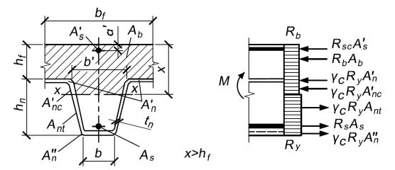
Рисунок 6.4— Схема усилий в пролетном сечении плиты при расположении нейтральной оси в пределах стенки гофра профилированного настила
