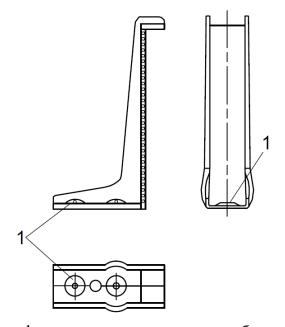
1 – отверстие для установки дюбеля Рисунок 5.3 – Пример уголкового анкерного упора
