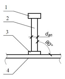
1— головка анкера; 2 — анкер; 3 — сварка; 4 — опорная балка Рисунок 5.2 — Стержневой упор (стад-болт)
