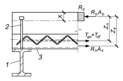
1 – прогон; 2 – анкер; 3 – стальной профилированный настил Рисунок 6.9 – Схема усилий при расчете по прочности анкеровки
