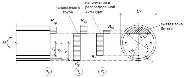
Рисунок 7.2 — Схема усилий и эпюра напряжений в сечении, нормальном к продольной оси изгибаемого трубобетонного элемента, при его расчете по прочности
