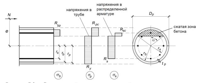
Рисунок 7.3 — Схема усилий и эпюра напряжений в сечении, нормальном к продольной оси внецентренно сжатого трубобетонного элемента, при расчете его по прочности
