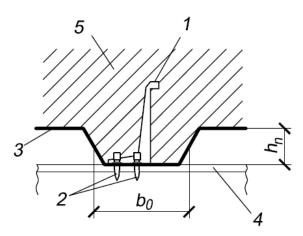
1— уголковый анкер; 2 — дюбель; 3 — настил; 4 — опорная балка; 5 — бетон плиты Рисунок 8.1 — Расположение уголкового упора вдоль оси балки
