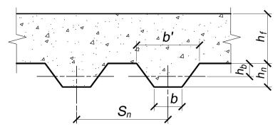
Рисунок 6.1 – K определению приведенной толщины бетона в пределах высоты сечения настила
