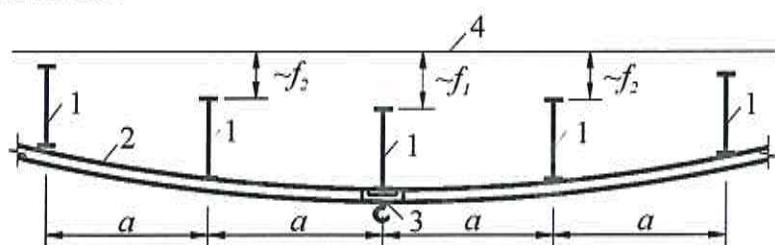
1 – стропильные конструкции; 2 – балка подвесного кранового пути; 3 – подвесной кран; 4 – исходное положение стропильных конструкций;  $f_1$  – прогиб наименее нагруженной стропильной конструкции;  $f_2$  – прогибы смежных с наименее нагруженной стропильных конструкций
