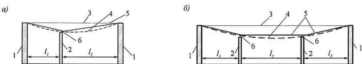
*a – одной в пролете; б – двух в пролете; 1 – несущие стены (или колонны); 2 – капитальные перегородки; 3 – перекрытие (покрытие) до приложения нагрузки; 4 – перекрытие (покрытие) после приложения нагрузки; 5 – линии отсчета прогибов; 6 – зазор*
