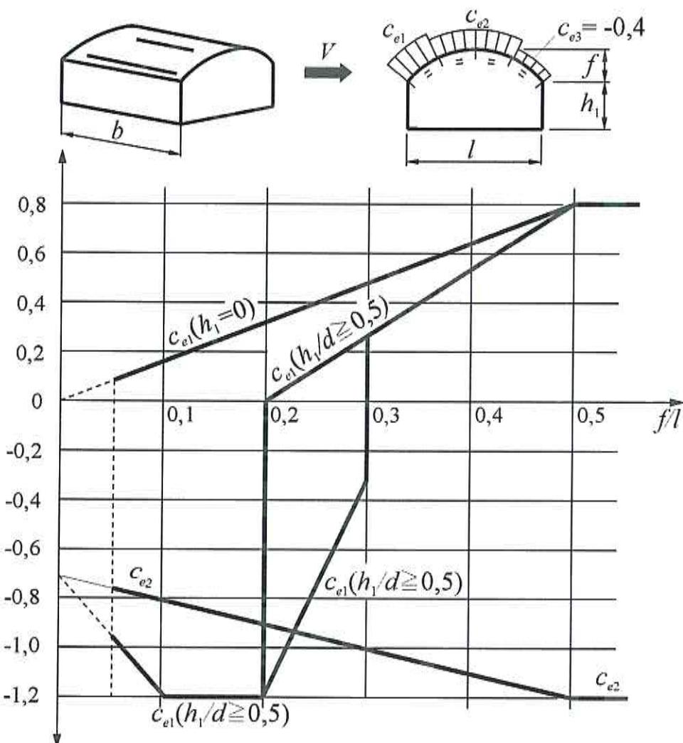
П р и м е ч а н и е – При  $0,2 \leq f/d \leq 0,3$  и  $h_1/d \geq 0,5$  необходимо учитывать два значения коэффициента  $c_{e1}$ .
