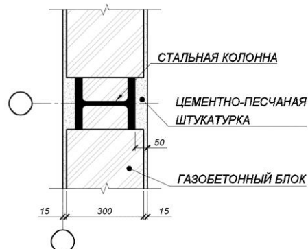
СТАЛЬНАЯ КОЛОННА ВО ВНУТРЕННЕЙ СТЕНЕ
