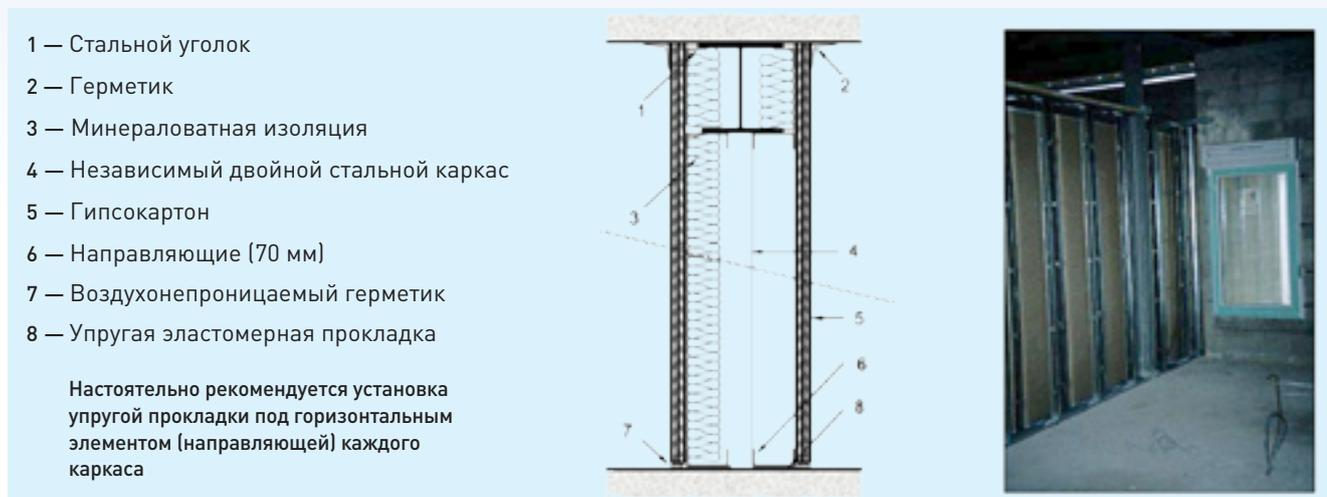
Рисунок 6.6. Двухслойная перегородка
