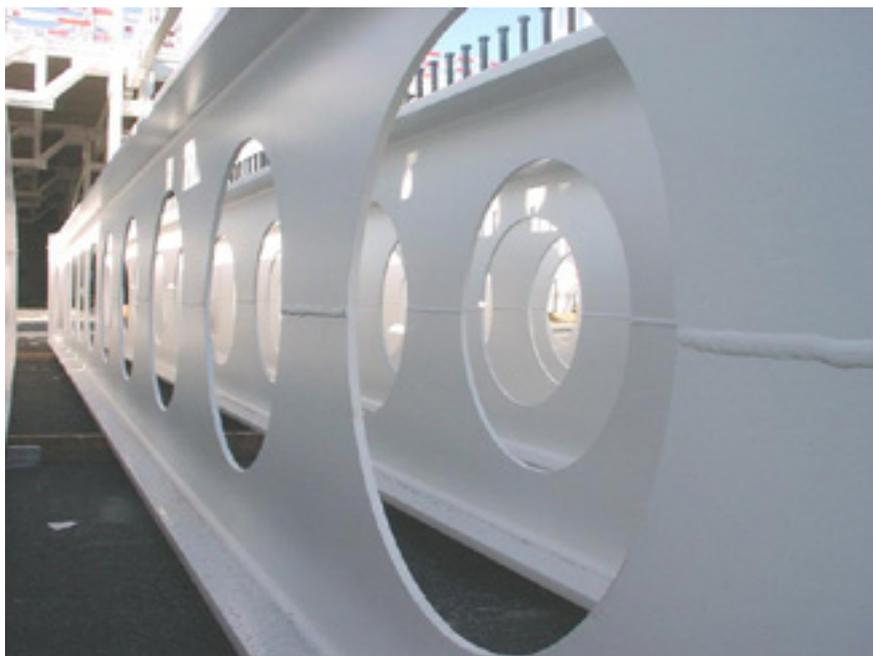
Рисунок 3.3. Балки с перфорированными стенками, изготовленные из прокатных профилей
