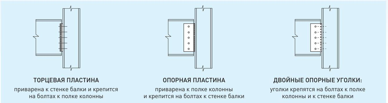
Рисунок 4.20. Типовой узел опирания балки на колонну
